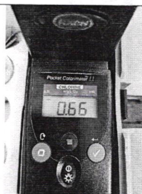
Fotografía 12. Medición de Cloro Residual in situ.
