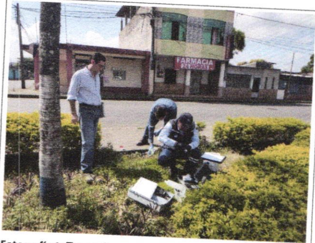
Fotografía 8. Toma de muestras en la red de distribución.
